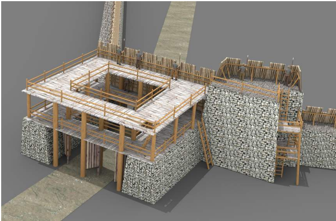
Fig. 136 : Gergovie, porte sud. Restitution graphique de la porte sud et de la tour TR 26/27, vue de l'intérieur. La cage d'escalier est intégrée dans l'angle nord-ouest de la tour.
